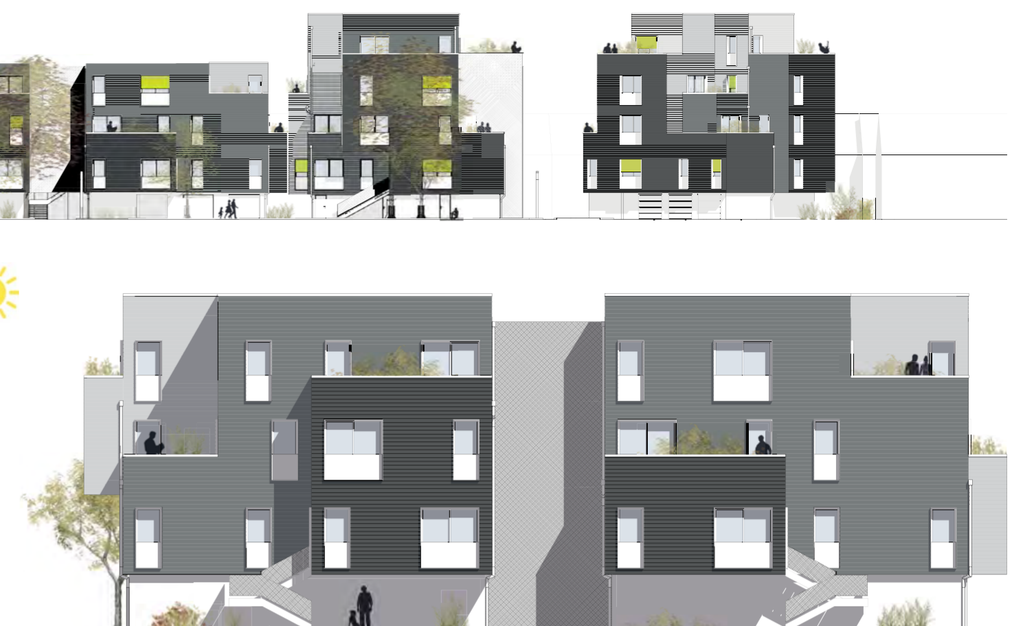
FACADE SUD - Jeu de volumes : offrir des espaces extérieurs généreux en limitant les vis à vis
